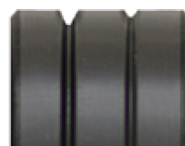
Valjak s V otvorima (za čvršće žice)
