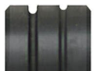
Valjak sa U otvorima (za mekše žice)
