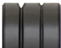
Valjak s V otvorima (za čvršće žice)
