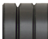
Valjak s V otvorima (za čvršće žice)
