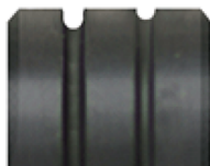
Valjak sa U otvorima (za mekše žice)
